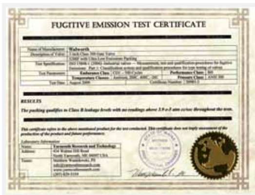
Certificado de Emisiones Fugitivas de 500 ciclos para válvulas de compuerta de 3" clase 300# Emitido por Yarmouth Research and Technology, que califican toda la gama de productos de Acero Fundido.
